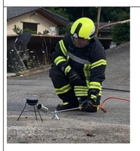
Erhitzt das Öl mit einem Brenner. Lasst die Stange mit dem Becher und dem Wasser abseits, so dass während dem Erhitzen kein Wasser ins heiße Öl gelangen kann.
